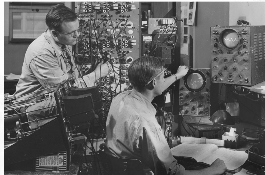
研发人员在辐射实验室测试雷达信号的场景
